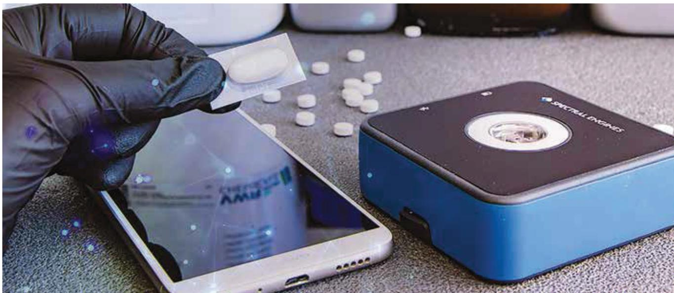
Sichere Pille: In dem blauen Gehäuse steckt ein Miniaturspektrometer, das Medikamentenfälschungen via Smartphone erkennt
