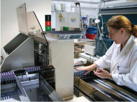
Der innovative Sortierautomat für geschlossene Blutprobenröhrchen HCTS2000 MK III ist in der Lage nicht nur lose Blutproben zu erfassen und zu sortieren. Vielmehr bestückt er Racks zur weiteren Verarbeitung im Labor mit den sortierten Proben in einem Arbeitsgang mit der Erfassung und Sortierung. Dabei sind kundenspezifische Anforderungen bezüglich der Anzahl und Typen der zu bestückenden Racks individuell zu realisieren.
